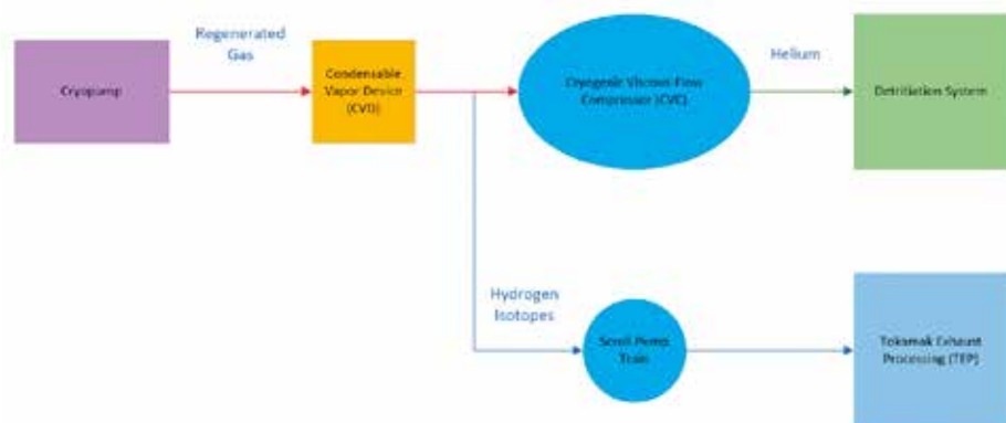
Figuur 4. Stroom van geregenereerd gas in de cryogene oplossing.
