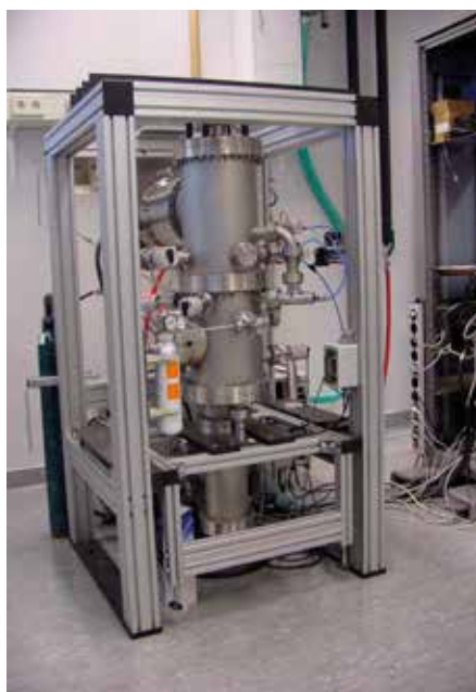
Figuur 2. Bij TNO werkte Koster aan de ontwikkeling van de Dynamic Gas Lock (DGL), een techniek om in vacuüm een schone en een vieze ruimte van elkaar te scheiden zonder gebruik van een venster.
