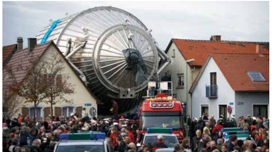
Figuur 2. Een van de stops tijdens de rondleiding langs de onderzoeksfaciliteiten van KIT is de grote UHV-kamer van de KATRIN-hoofdspectrometer (hier op transport naar KIT), die 24 meter lang is en werkt bij een druk van 10^{-11} mbar. (Bron: Forschungszentrum Karlsruhe)
